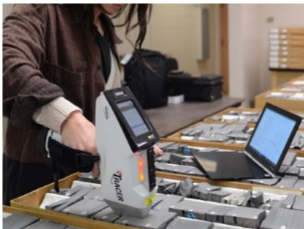
圖 27、新型掌上型 XRF，不須另接線路連接電腦。
