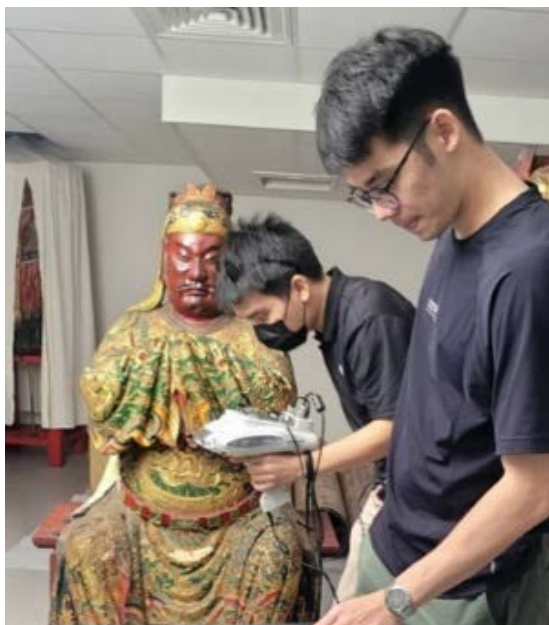
圖 13、修復前 XRF 顏料層分析檢測。
