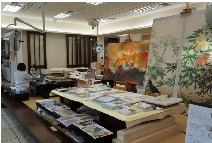
圖 12、為確保專業修護訓練的高品質，敏感及脆弱材質的文物修護皆在符合國際標準的修復室中進行，並由專業團隊全程指導。MCCH 修護室環境管理：比照美術館環境，全日安全監控與門禁管理、溫濕度控制（溫度 22\pm 3^{\circ}\text{C} 、相對濕度 50~55%）、無紫外線、高演色性照明與定時災害防治檢驗。如此的專業環境，不但將修護中的不穩定因素降至最低確保修護技術品質，也保障文物修護期間的安全。
