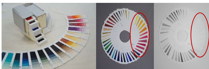
圖 18、推動「修復家的調色盤」-非可視光辨識法：在各種不同光線照射下，不同材質產生不同色差之修復補彩應用技法研究，促進修復家的調色盤具有功能性與規則性，使補彩作業逐漸規則化。
