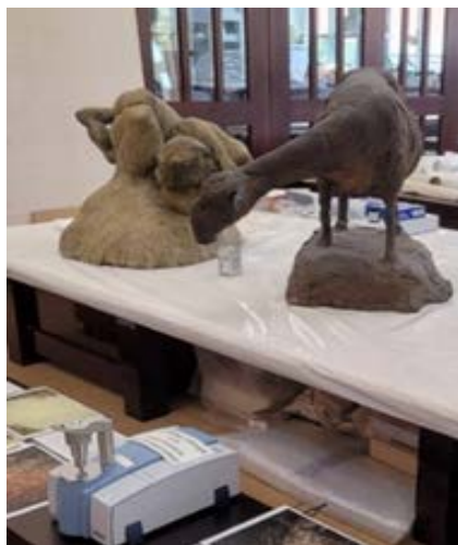
圖 15、金屬文物實務修復操作與使用紅外線分析儀 (FTIR) 檢測金屬作品表層塗膜材質
