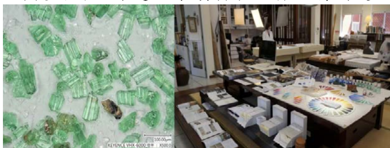
圖 17、介紹具有亞洲顏料代表性的天然礦物質顏料的材質與古法製造方式：將天然礦石粉碎後，以「水漂法」將顏料顆粒分類，依照顆粒大小分類為深淺不一的漸層色調從深到淺，並且擁有寶石般的閃爍光澤與結晶。
